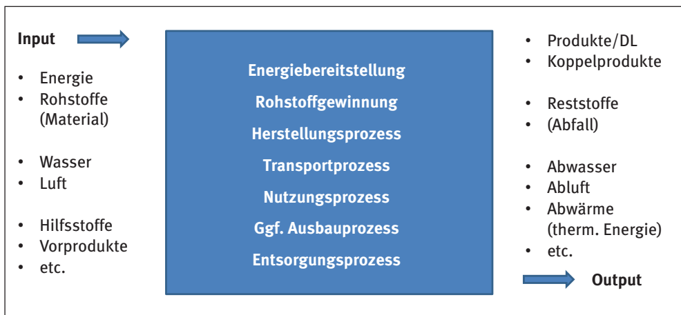
Bild 3.13: Produktsystem in der Ökobilanz
